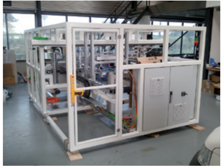
De automatisering staat klaar voor verzending naar Amerika. Zichtbaar zijn het toegangshek naar de matrijs en de besturingskast met de servodrivens.
