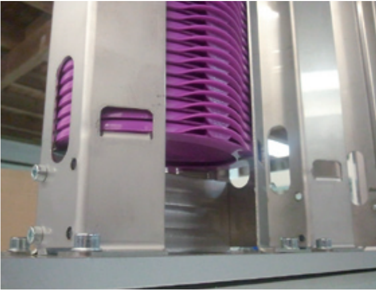
Producten gestapeld in het magazijn, dat uit één stuk met lasersnijden en zetwerk is gemaakt.
